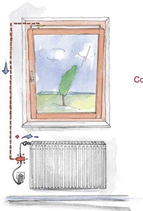
**Contacts électromagnétiques MTS :** Réduisent la consommation d'énergie en réduisant le chauffage là où une fenêtre est ouverte :
