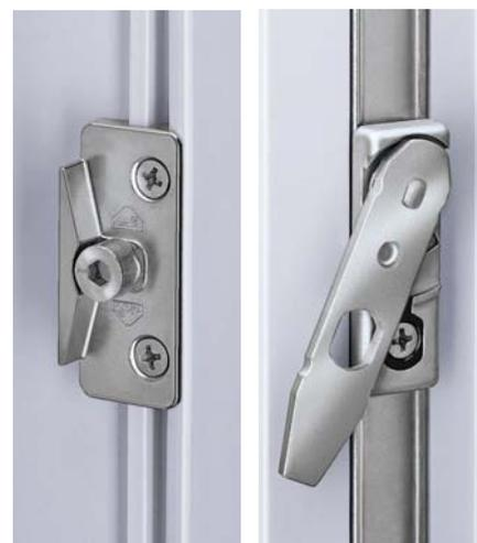
**Galet de verrouillage type V**. Réglage tri-directionnel, verrouillage et sécurité avec un seul accessoire. Le verrouillage avec un galet **V** permet une sécurité anti-décrochement conforme à celle demandée pour les fenêtres de sécurité type DIN V ENV 1627-1630 (classes 1 et 2).
