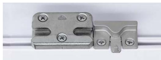
**Raccordement des composants par jonction à clipper.** Ce nouveau système assure toujours la continuité de fixation entre les têtes. Il permet une liaison facile et rapide entre les composants avec seulement une vis. La languette de recouvrement devient inutile : plus de surépaisseur en feuillure.
