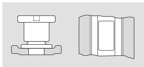
**Entrebâilleur « Jour & Nuit » (option).** Économique et discret, il se fixe très aisément à côté de la gâche de la transmission équerre. Sa fonction se déclenche par la manœuvre de la poignée.
